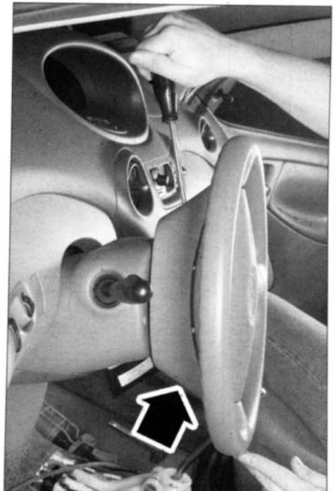
Dépose d'une vis de fixation d'airbag (l'autre est située à l'opposé).
